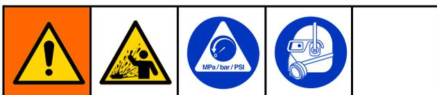
Questa apparecchiatura rimane pressurizzata finché la pressione non viene scaricata manualmente. Per evitare lesioni gravi causate dal fluido pressurizzato, ad esempio schizzi di fluido, seguire la **Procedura di scarico della pressione** quando si smette di erogare e prima di pulire, verificare o eseguire la manutenzione dell'apparecchiatura.
